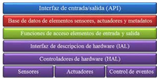
Figura 4: Modelo de interfaz para sensores y actuadores
