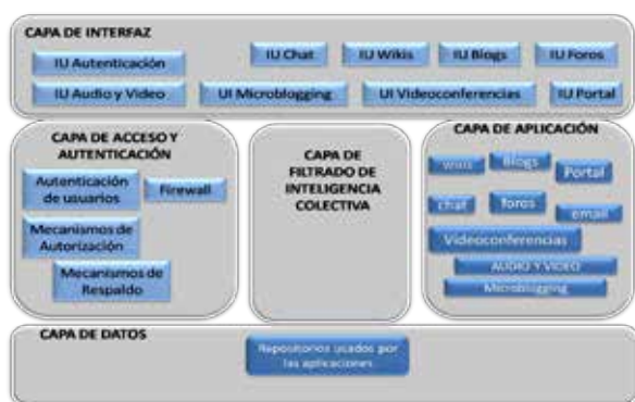
Figura 2: Arquitectura usada para la infoestructura de colaboración integrada al flujo de trabajo
