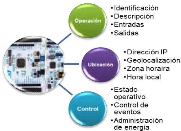
Figura 3: Modelo de datos de un objeto inteligente
