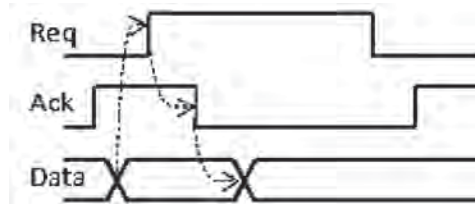
Fig. 5. Señalización 2 Fases (Single rail)
